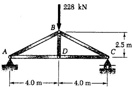
1. Oheisen ristikön sauvojen varmuusluvun myödön suhteen tulee olla vähintään 1,5. Valitse kullekin sauveille poikkipinta-ala joukosta  $600 \text{ mm}^2$ ,  $800 \text{ mm}^2$ ,  $1000 \text{ mm}^2$ ,  $1200 \text{ mm}^2$ ,  $1400 \text{ mm}^2$ ,  $1600 \text{ mm}^2$ ,  $1800 \text{ mm}^2$  ja  $2000 \text{ mm}^2$  niin, että ristikosta tulee mahdollisimman kevyt. Nurjahdusta ei tarvitse huomioida.  $E = 200 \text{ GPa}$ ,  $R_e = 220 \text{ MPa}$  ja  $R_m = 330 \text{ MPa}$ .
