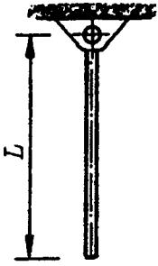
1. Poikkileikkauskeltaan pyöreä ( $d = 20 \text{ mm}$ ) tasapaksu terässauva ( $R_e = 235 \text{ MPa}$ ,  $\rho = 7850 \text{ kg/m}^3$ ,  $E = 210 \text{ GPa}$  ja  $\nu = 0,3$ ) roikkuu toisesta päästä.
