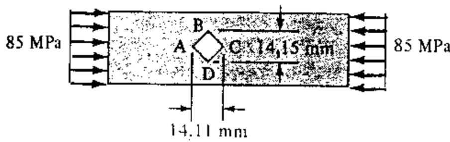
1. Kuormittamattomalle levyllä on piirretty neliö, jonka sivun pituus on 10 mm. Sen jälkeen levyä kuormitetaan oheisen kuvan mukaisesti. Neliö muuttuu vinoneliöksi, jonka mitat näkyvät kuvasta. Määritä levyn materiaalin kimmomoduuli  $E$  ja Poissonin vakio  $\nu$ .
